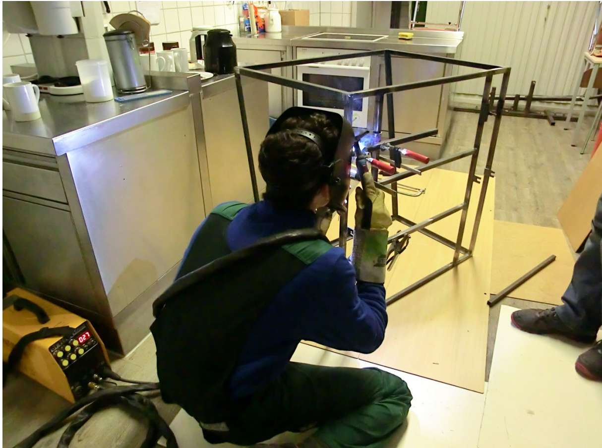
Foto: Schweißarbeiten am Rahmen für das Lastenfahrrad (Foto: S.T.E.R.N. GmbH)
